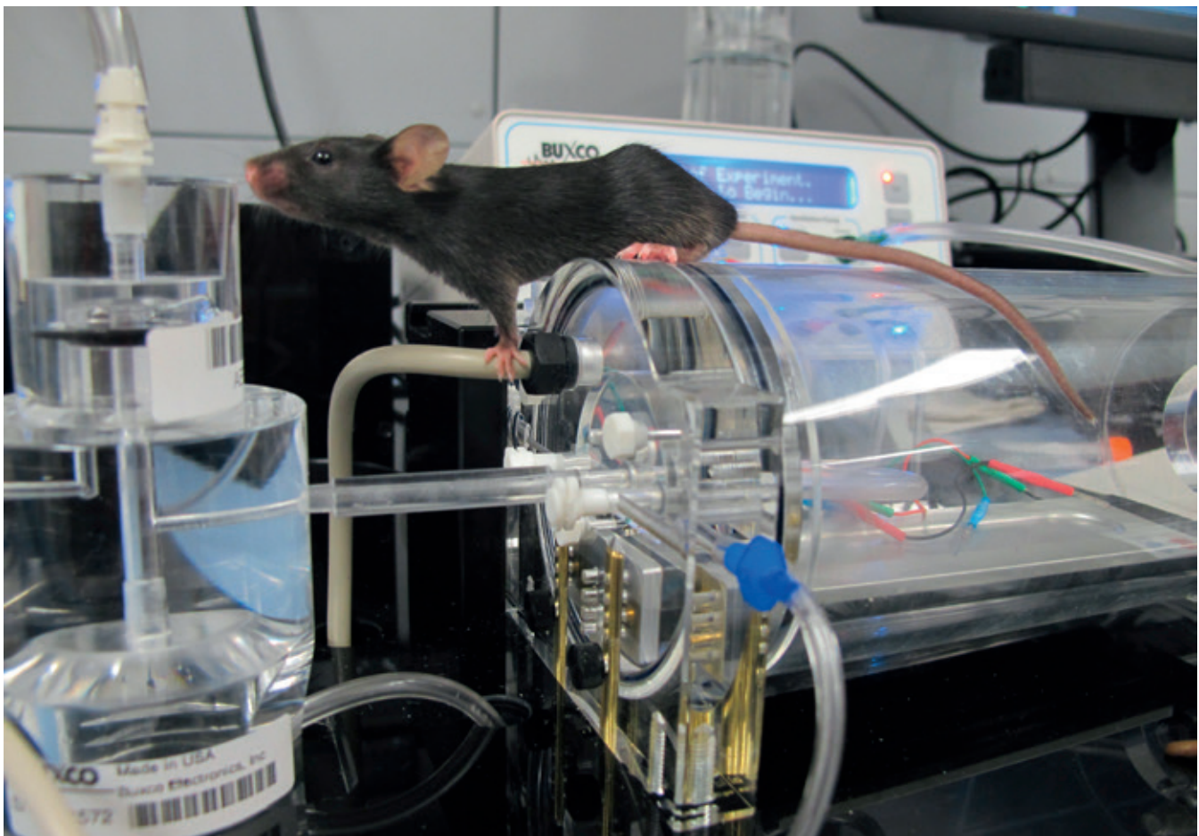
Abbildung 4: Eine C57BL/6-Maus interessiert sich für das zur Lungenfunktionsanalyse verwendete System, das z. B. zur Bestimmung des Atemwegswiderstandes und dessen Veränderung durch Metacholin eingesetzt wird. (Abb. mit freundlicher Genehmigung von Dr. M. Wegmann, Forschungszentrum Borstel)
